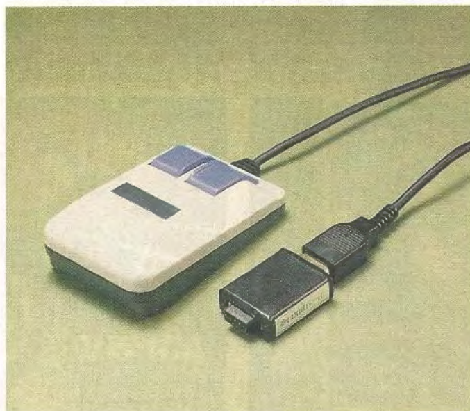
Bild 11. Die Scantronik-Maus wird mit dem mitgelieferten Interface-Zwischenstück am Joystickport angeschlossen
